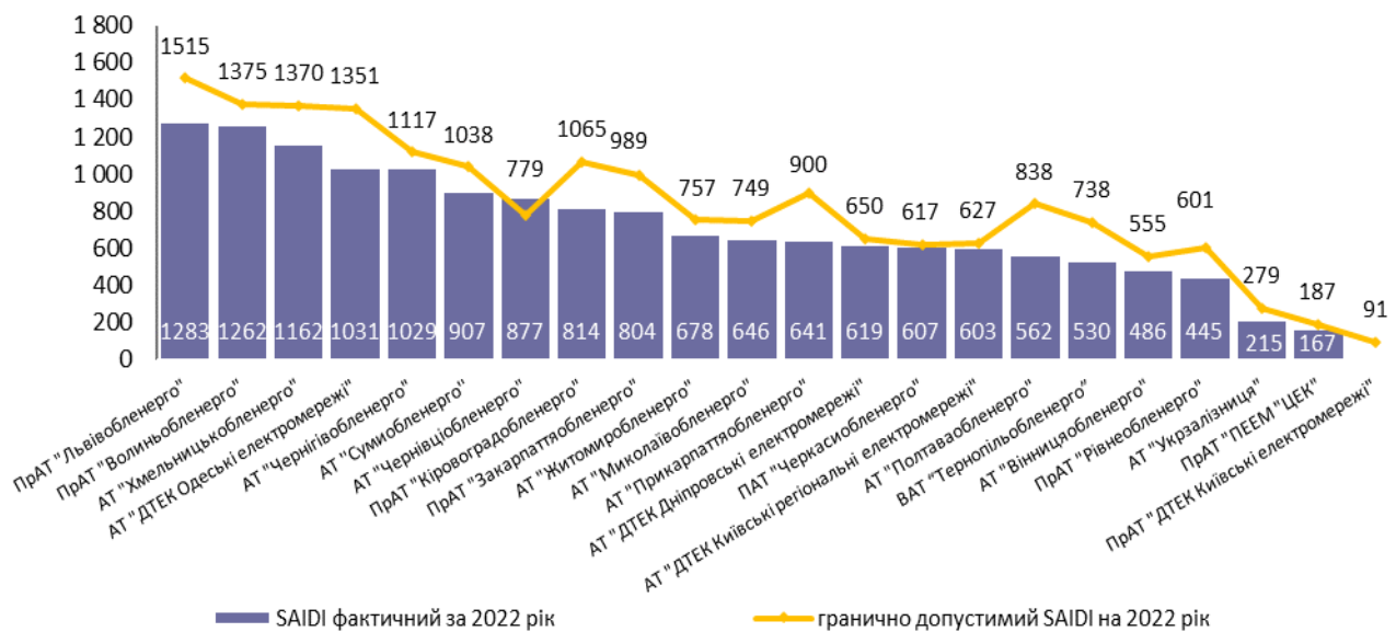
Рис. 1.7. Фактичні значення індексів SAIDI з вини компанії на рівні напруги 0,4- 20 кВ у 2022 році та гранично допустимі (цільові) значення SAIDI для сільської території для компаній, з кількістю споживачів більше 100 000, на 2022 рік
